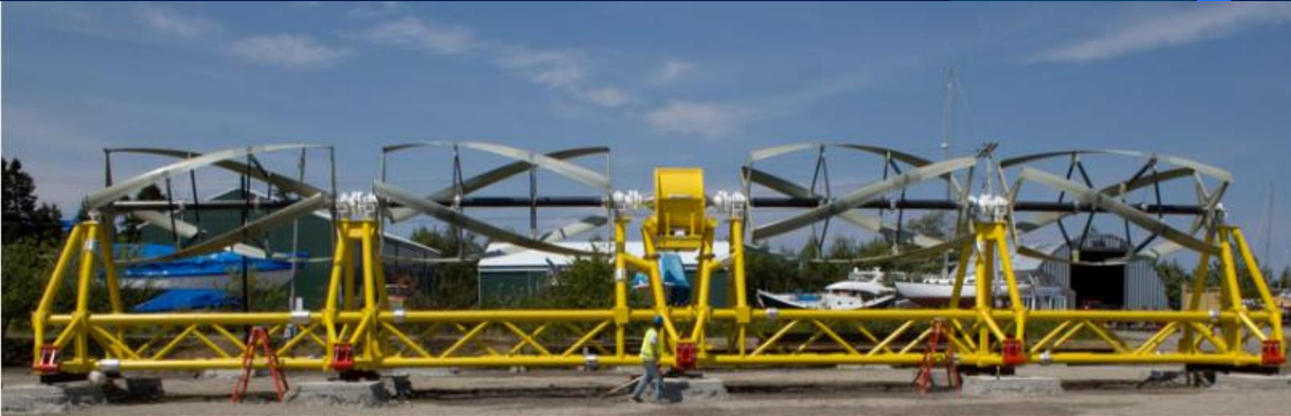
El Sistema de generación de energía consiste tres principales subsistemas: centro electrónico en tierra; Sistema de fijación o amarre; y dispositivo de fenerator turbine (TGU).
