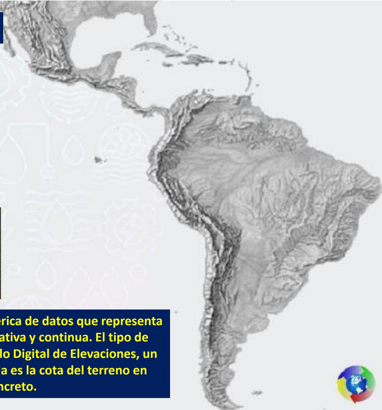
Un Modelo Digital de Terreno (MDT) es una estructura numérica de datos que representa la distribución espacial del terreno de una manera cuantitativa y continua. El tipo de Modelo Digital del Terreno (MDT) más conocido es el Modelo Digital de Elevaciones, un caso particular de aquel, en el que la variable representada es la cota del terreno en relación a un sistema de referencia concreto.
