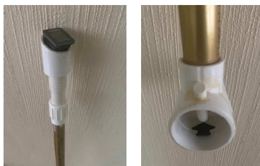
Figura 3. Aforador volumétrico. Incluye una pequeña computadora para el análisis y despliegue de información
