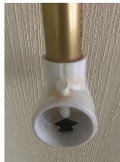
**Figura 3.** Aforador volumétrico. Incluye una pequeña computadora para el análisis y despliegue de información
