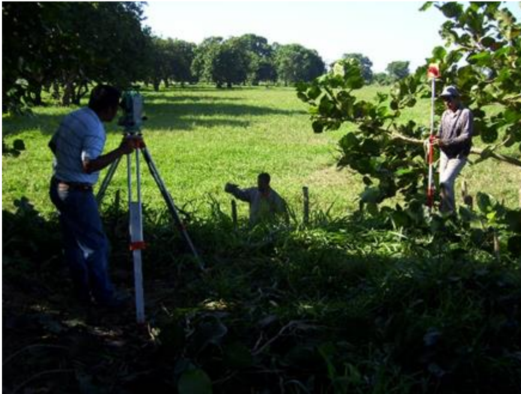
Figura 2. Levantamiento topográfico: perfil y secciones trasversales
