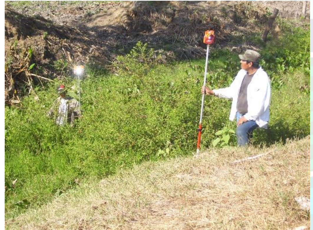
Figura 2. Levantamiento topográfico: perfil y secciones trasversales
