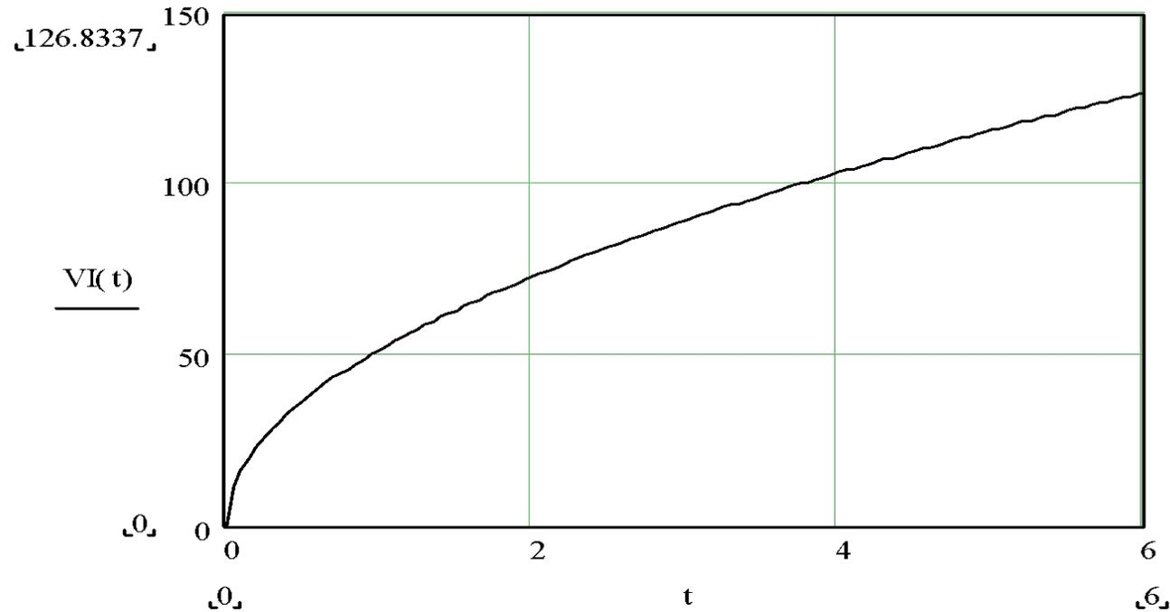
Evolución temporal del volumen infiltrado por un tubo de 6" de diámetro, con pared porosa, de 500m de longitud, enterrado a una profundidad media 1.2m, con una pendiente 0.001, y completamente lleno de agua. El volumen está en  $m^3$  y el tiempo en horas.
