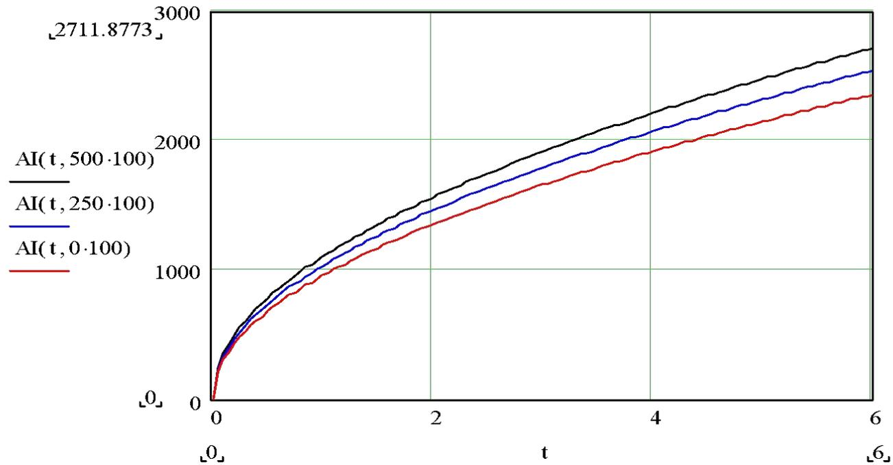
Evolución del volumen infiltrado por unidad de longitud en las secciones: i)0m, inicio; ii)250m, mitad; iii)500m, final. La ordenada está en  $\text{cm}^2$  y el tiempo en horas.
