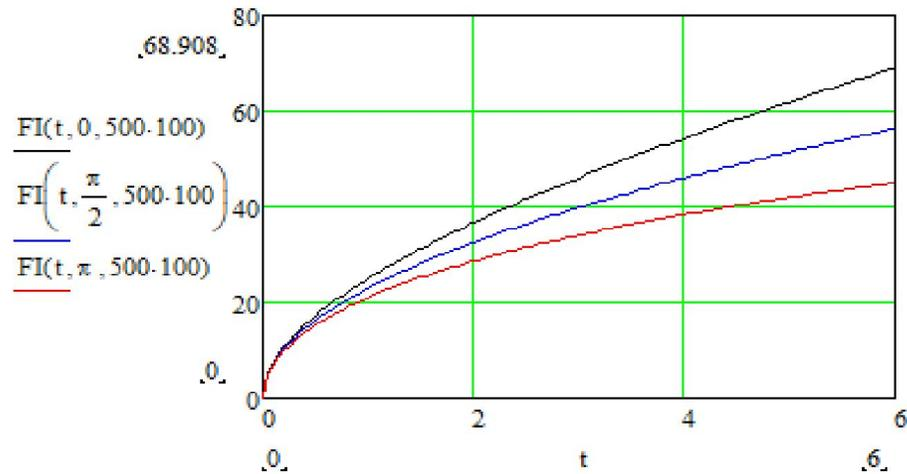
Evolución de la lámina infiltrada en la sección posicionada en a)0m, b)250m, c)500m, en las columnas ubicadas, respectivamente, en  $\omega = 0, \pi / 2, \pi$ . La ordenada está en  $\text{cm}^2$  y el tiempo en horas.
