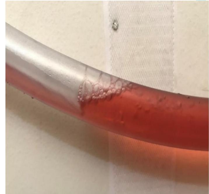
**Figura 13.** Salto hidráulico aguas abajo de bolsa de aire en conducto inclinado.
