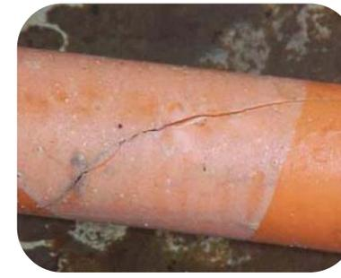
**Figura 3.** Rotura por sobrepresión.
