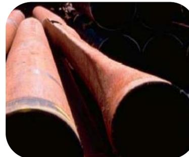
**Figura 2.** Colapso por succión.
