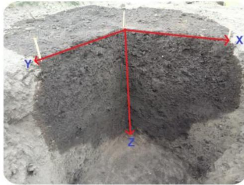
**Figura 1.** Esquema de la obtención del avance horizontal y vertical del agua y la geometría del bulbo húmedo bajo un emisor, después de un tiempo de riego dado.
