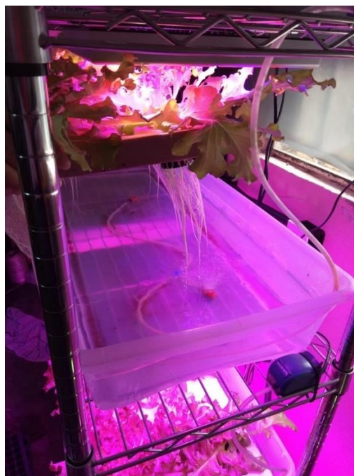
Figura 3. Dispositivo para oxigenar la solución en el contenedor
