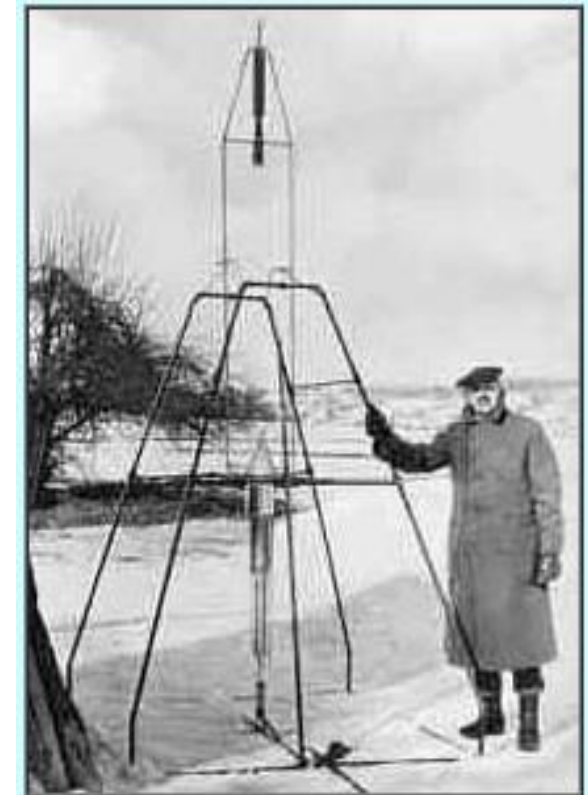
Robert H. Goddard al lado del cohete de combustible líquido en 1926. El cohete está en la parte superior, recibiendo su combustible por dos líneas desde el tanque en la base.
