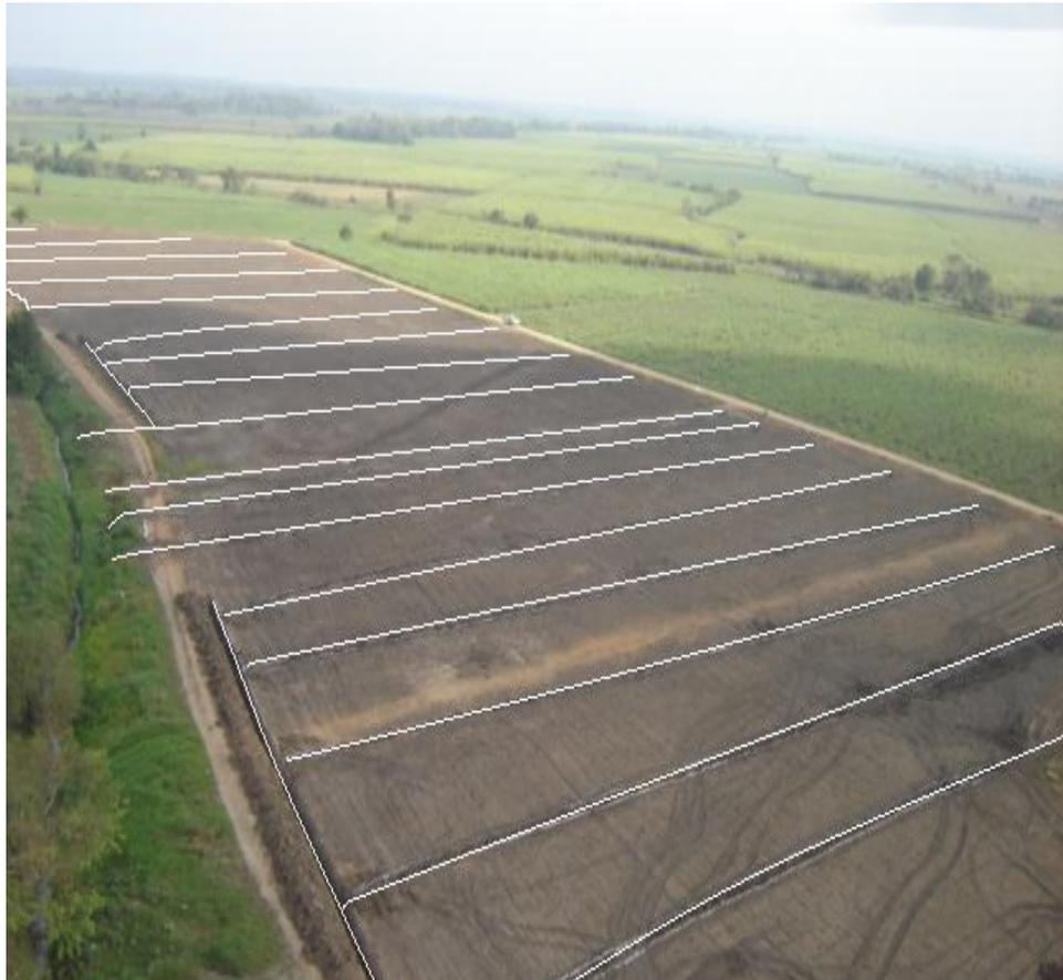
cinco drenes laterales de 4" de diámetro a separación de 30 m con pendiente de 0.1%, que descargan al colector E de 8" de diámetro con pendiente de 0.1% y cinco drenes laterales de 4" de diámetro a separación de 40 m con pendiente de 0.1%. Los tres colectores subterráneos A, E y F; así como tres drenes laterales B, C y D descargan al dren a cielo abierto Palma-Higuera.
