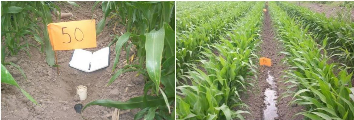
**Figura 1.** Estimación de la conductividad hidráulica con el método del miniinfiltrómetro y medición de la fase avance de riego
