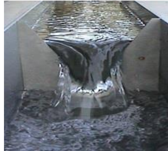
Fig.1 Vertedor de pared gruesa y pared delgada
